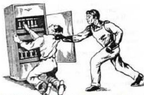
Рис. 4. Освобождение пострадавшего от токоведущей электрического тока
