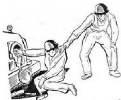
Рис. 3. Освобождение пострадавшего от действия части, находящейся под напряжением до 1000 В
